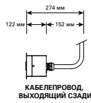
КАБЕЛЕПРОВОД, ВЫХОДЯЩИЙ СЗАДИ
